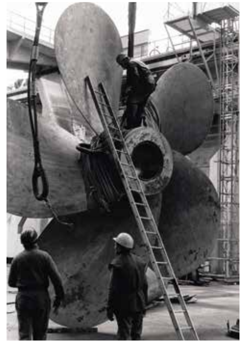
Drie arbeiders aan het werk tijdens de montage van een bronzen schroef op de scheepswerf Boel in Temse. Collectie Amsab-ISG Foto: Karel Heirbaut
